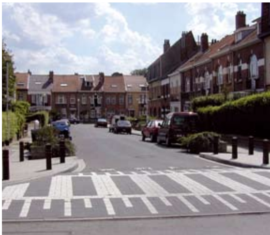
Entrée de zone 30 marquée par un ralentisseur de vitesse avec passage piéton. À noter également le raccourcissement de la traversée par des oreilles.
