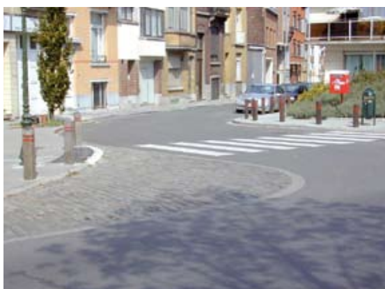
Des oreilles franchissables peuvent être prévues pour faciliter le passage de véhicules lourds.
