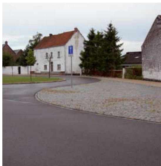
Des trottoirs très larges ne sont pas toujours nécessaires. L'espace repris dans le carrefour peut être laissé libre pour d'autres usages.
