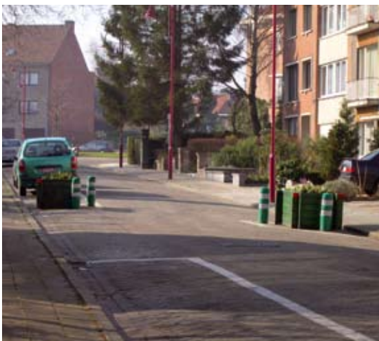
Dévoisement et rétrécissement réalisés avec du mobilier, des potelets souples et des marquages.
